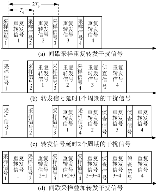
图 1 基于延时叠加的间歇采样干扰生成原理图
