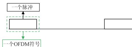
图 1 传统 OFDM 雷达信号波形形成示意图
